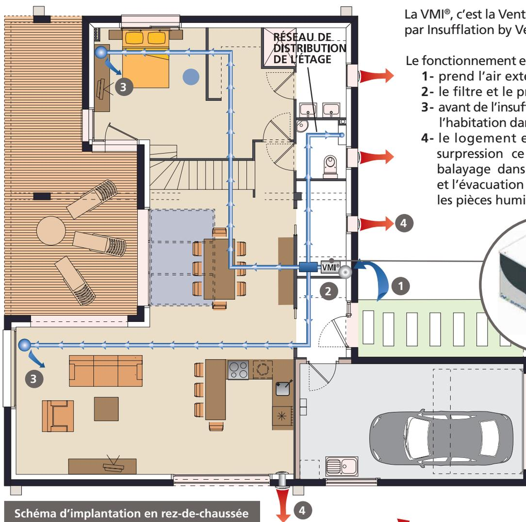
La VMI®, c'est la Ventilation Mécanique par Insufflation by Ventilairsec.
